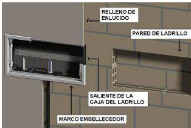
PLANO MONTAJE CAJA REF. 23260 El montaje es el mismo para toda la serie
